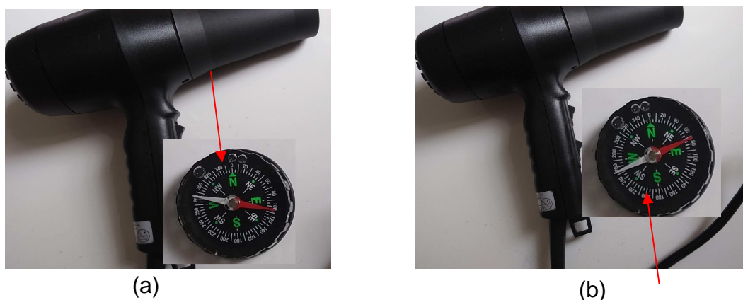
Figura 1.14 – Imagem fotográfica: (a) secador desligado e (b) ligado, mostrando a deflexão da agulha na bússola posicionada perto do cabo de um secador de cabelo do efeito liga-desliga. Essa deflexão é análoga à observada por Oersted.
