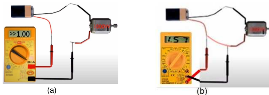
Figura 2.23 – Imagens de medida de (a) corrente e (b) tensão usando-se um multímetro.
