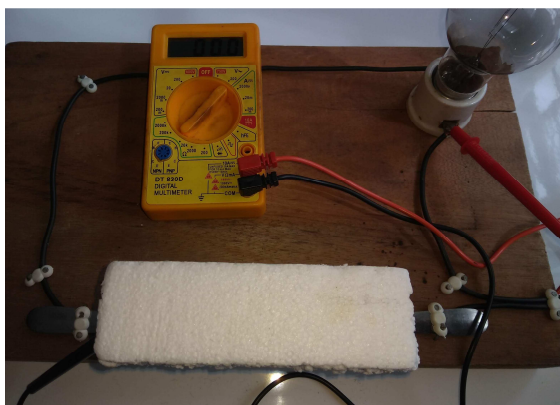
Figura 2.33 – Imagem fotográfica do circuito com o isopor® como amostra. Tensão 0,00 V
