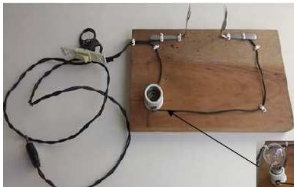
Figura 2.21 – Imagem fotográfica do Aparato Experimental – um circuito elétrico simples em série, contendo, uma base de madeira, fios de cobre, soquete com lâmpada (em destaque na parte inferior), interruptor (questão de segurança), fio com terminal para a tomada (plugue) e dois garfos
