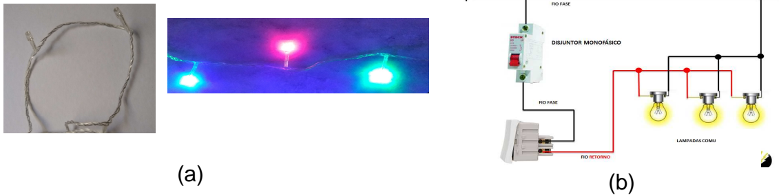
Figura 1.17 – (a) Imagem da ligação em série das lâmpadas de enfeite de Natal. (b) Indicando a ligação em paralelo no circuito de residências
