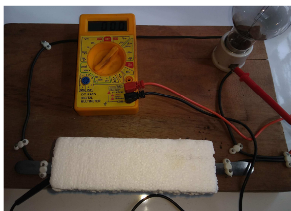
Figura 2.20 – Imagem fotográfica do circuito com o isopor® como amostra. A tensão é de 0,00 V.
