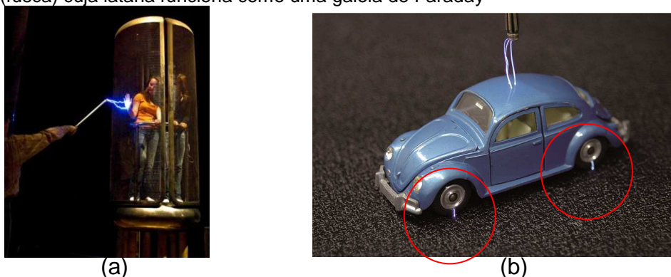
Figura II.3 – Imagem fotográfica: (a) de uma pessoa dentro de uma gaiola de Faraday e em (b) um carro (fusca) cuja lataria funciona como uma gaiola de Faraday
