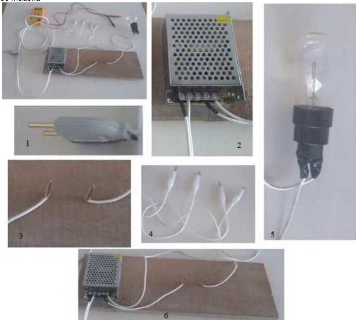
Figura I.2 – Foto do aparato experimental: (1) plugue a ser conectado na tomada externa; (2) fonte 12 volts; (3) local onde será colocada a amostra; (4) fio; (5) lâmpada no soquete; (6) base de fixação de madeira
