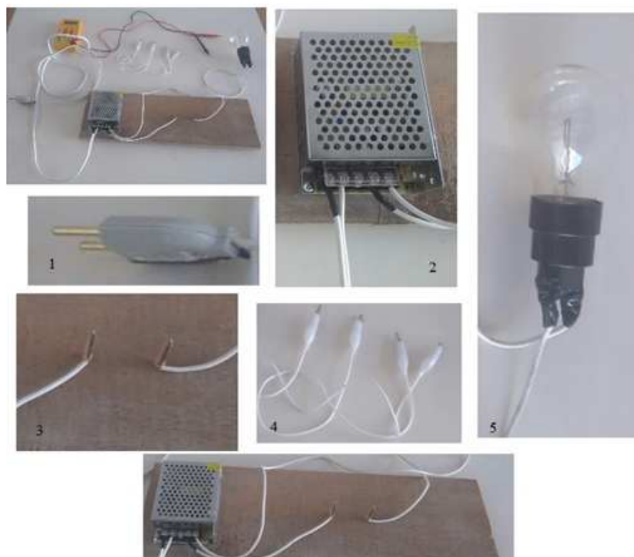
Figura A.2 – Foto do aparato experimental: (1) plugue a ser conectado na tomada externa; (2) fonte 12 volts; (3) local onde será colocada a amostra; (4) fio; (5) lâmpada no soquete; (6) base de fixação de madeira.
