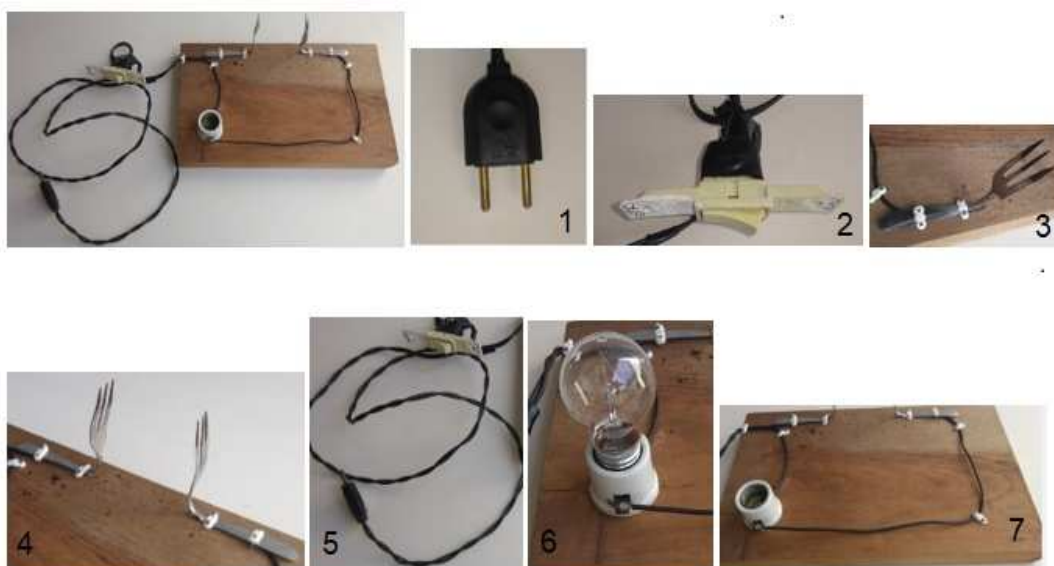
Figura 1.1. Foto do aparato experimental: (1) plugue a ser conectado na tomada externa; (2) interruptor; (3) garfos; (4) local onde será colocada a amostra; (5) fio; (6) lâmpada no soquete; (7) base de fixação de madeira
